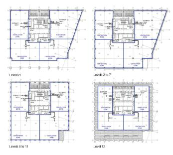
FIGURE 5.1 - VENTILATION CONTROL ZONES & VAV ARRANGMENT
